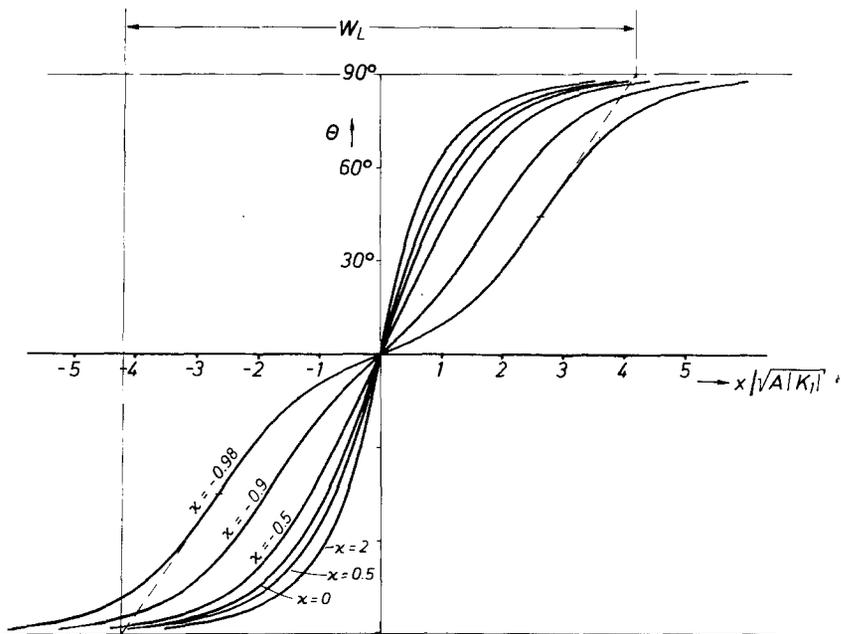
Fig. 2.2 Der Wand-Drehwinkel  $\theta(x)$  für verschiedene Wände in einachsigen Materialien.  $\kappa = K_2/K_1$  = Verhältnis der beiden Anisotropiekonstanten. Definition der Wandweite nach Lilley (für die Kurve  $\kappa = -0.98$ )
